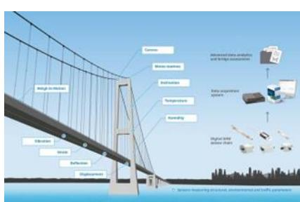
Kistler stellt seine vollständig digitale Structural Health Monitoring Lösung zur Zustandsüberwachung von Brücken erstmals auf der Intertraffic 2026 in Amsterdam vor (Halle 1, Stand 410, 10.–13. März). Das modulare Messsystem bietet eine kontinuierliche Überwachung und Echtzeit-Einblicke in die Struktur, um eine proaktive Instandhaltung zu unterstützen, die Lebensdauer von Brücken zu verlängern und die Verkehrssicherheit zu verbessern.
