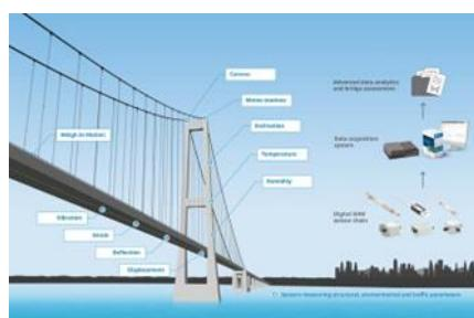
Kistler stellt seine vollständig digitale Structural Health Monitoring Lösung zur Echtzeitüberwachung von Brücken erstmals auf der Intertraffic 2026 in Amsterdam vor (Halle 1, Stand 410, 10.–13. März). Das modulare Messsystem bietet Echtzeit-Einblicke in den Brückenzustand, um eine proaktive Instandhaltung zu ermöglichen, die Lebensdauer zu verlängern und die Verkehrssicherheit zu erhöhen.
