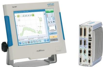
Mit Kraft- und Wegüberwachung in Echtzeit, Trägheitskompensation und Kurvenauswertung ermöglicht Kistler die Inline-Überwachung jedes Montageschritts für Medizinprodukte. Das FDA- und MDR-konforme Prozessüberwachungssystem maXYmos TL ML von Kistler ermöglicht die lückenlose Teileprüfung und ist mit einem Audit-Trail ausgestattet.
