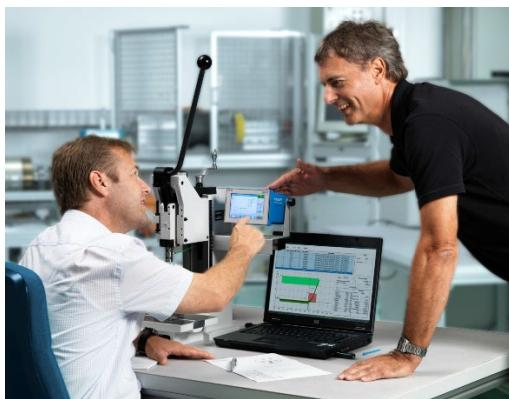
Giunzione e assemblaggio: gli utenti possono analizzare tutti i dati di produzione con maXYmos Analyzer per ottimizzare i processi, ad esempio per evitare parti difettose e perdite di qualità.
