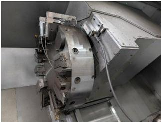
Das Telemetrische Messsystem von Kistler ermöglicht erstmals die kabellose Signalübertragung zur präzisen Prozessüberwachung direkt am Werkzeugrevolver.
