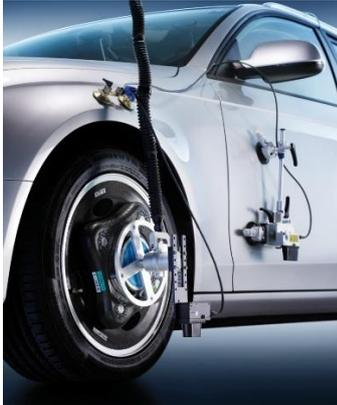
Die auf Testfahrzeugen montierten hochdynamischen Beschleunigungs- und Laser-Höhensensoren erfassen die Profile der Straßenoberfläche in außergewöhnlich hoher Auflösung und bilden damit die Grundlage für eine genaue Zustandsbewertung des Straßenbelags während der Bauphase.
