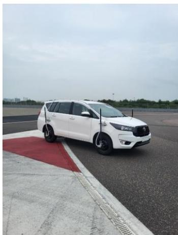
Kistler und die indischen Infrastrukturbehörden arbeiteten zum ersten Mal zusammen, um ein Echtzeit-Messsystem zur Zustandserfassung des Straßenbelags beim Bau von Schnellstraßen einzuführen. Dieses erkennt Probleme mit der Oberflächenqualität von Straßen sofort und ermöglicht die Überwachung der Straße nach Inbetriebnahme.
