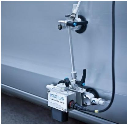
Die Kombination von optoelektronischen Geschwindigkeitssensoren und Trägheitssensoren generiert präzise Bewegungs- und Geschwindigkeitsdaten für jeden Straßenabschnitt und erlaubt eine kontextbezogene Analyse der Qualität des Fahrbahnbelags.
