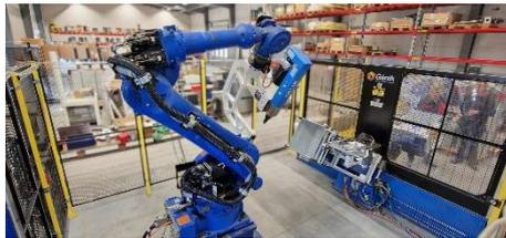
Die kompakte Servopresse NCFC mit integrierter Sensorik sorgt für präzises Clinchen auch am Roboter.
