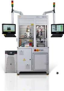
Das neue Inline Vision & Weld System mit Marking-on-the-Fly (IV&WS Marking) prüft Stanzteile auf Maßhaltigkeit und Oberflächendefekte. Dabei trennt es fehlerhafte Teile automatisch aus, schweißt den Stanzstreifen wieder lückenlos zusammen und beschriftet jedes Teil per Laser.
