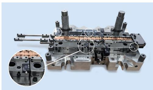
Vista dell'utensile di stampaggio: i sensori induttivi analogici sono integrati direttamente per ottenere un controllo del doppio foglio ad alta precisione in combinazione con il sistema di monitoraggio KCA 400T.
