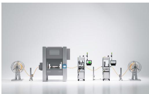
Per garantire la qualità nello stampaggio, Kistler offre sistemi di sensori per il monitoraggio dei processi, sistemi di ispezione ottica che includono software di elaborazione delle immagini all'avanguardia e marcatura laser automatica (marking-on-the-fly (MOF)).
