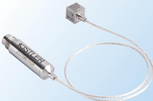
Der neue triaxiale IEPE-Beschleunigungssensor KiVibe Miniature von Kistler zeichnet sich durch ein sehr geringes Gewicht (0,9 Gramm), äußerst kompakte Abmessungen und durchweg ausgangsarme Komponenten aus.
