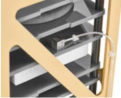
Progettato per strutture complesse con spazio limitato, l'accelerometro triassiale IEPE KiVibe Miniature di Kistler garantisce un montaggio flessibile ed efficiente.
