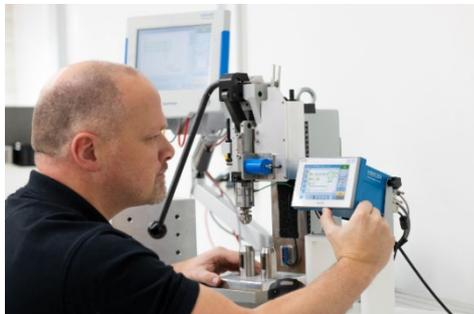
maXYmos BL consente il controllo al 100% e il monitoraggio continuo di forza e spostamento del processo di pressatura con una pressa manuale dotata di un sensore di forza integrato nel portautensili e di un sensore di spostamento.
