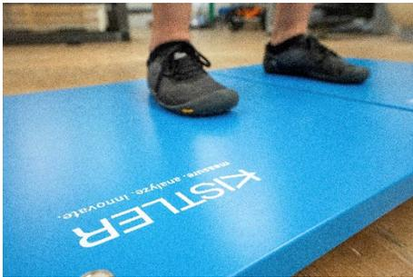
Die digitale 3D-Kraftmessplatte kommt vor allem bei biomechanischen Messungen für Ganganalysen und Leistungsdiagnostik zum Einsatz.
