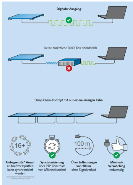
Die neue tragbare 3D-Kraftmessplatte mit integrierter Datenerfassung kombiniert die Vorteile von piezoelektrischen Sensoren und Digitalisierung: bis zu 16 Kraftmessplatten können in einer Kette mit minimaler Verkabelung miteinander verbunden werden.
