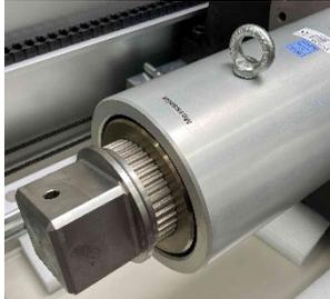
Mittels eines Referenzsensors kalibriert Kistler Analysensysteme für Schraubverbindungen rückführbar bis 60 kN m vor Ort.
