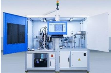
Mit dem neuen Multicapture Device entdeckt der Prüfautomat KVC 821 von Kistler selbst bei hoher Taktzeit kleinste Fehler auf der Manteloberfläche der Prüfteile.
