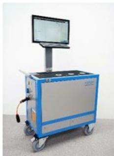
Mit dem Prüfsystem cerTEST lassen sich Drehmomentwerkzeuge wie Akku-, Dreh- und Impulsschrauber normkonform und mobil prüfen.
