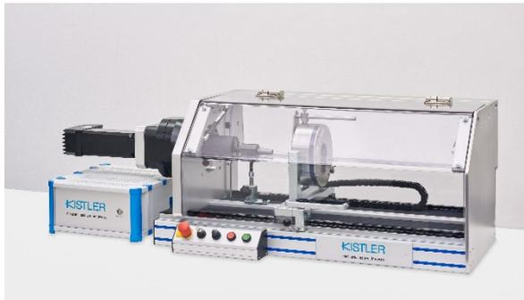
Der horizontale ANALYSE Schraubenprüfstand bringt Kräfte von bis zu 500 N·m auf.
