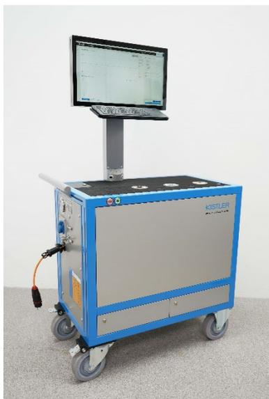
cerTEST, das System zur Prüfung von Drehmomentwerkzeugen von Kistler, sorgt für normkonforme Werkzeugprüfung.
