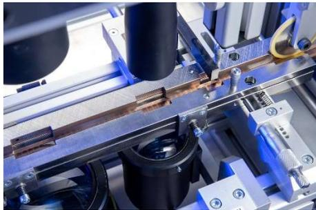
Die von Kistler entwickelte Bildverarbeitungssoftware KiVision detektiert Abweichungen von Maßen oder Konturen sowie relevante Oberflächendefekte und ermöglicht eine Anomaliedetektion auf Basis von künstlicher Intelligenz.
