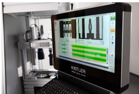
Die von Kistler entwickelte Software KiVision analysiert Prüfbilder, detektiert Abweichungen und erlaubt Anwendern, eigene Befehlsmakros anzulegen.
