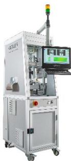
Mit dem neuen, kompakten Prüfautomat KVC 621 SE können Hersteller bis zu 4.000 Stanzteile pro Minute auf Defekte überprüfen.
