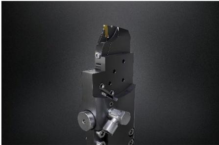
In Kooperation mit HORN hat Kistler das Piezo Tool System (PTS) entwickelt, um Zerspanungswerkzeuge für die Mikrobearbeitung laufend überwachen zu können – zu sehen auf der EMO Hannover. | © HORN/Sauermann
