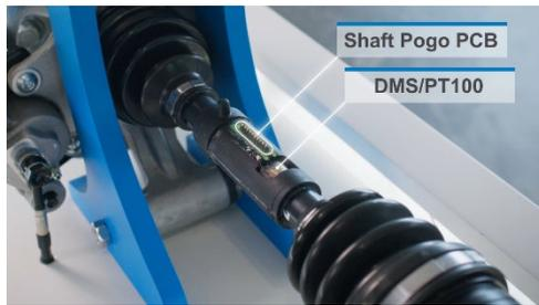
Der Adapter für den Sender ist für einen optimalen Sitz auf die Antriebswelle zugeschnitten.
