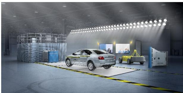
Dank integrierter Messsysteme für Crashtests von Kistler können Entwickler realitätsnahe Testsituationen nachbilden. Hier ist ein beispielhafter Aufbau mit Crashblock, Crashwand sowie einer festen und mobilen Multibarriere der Firma ERNST abgebildet.
