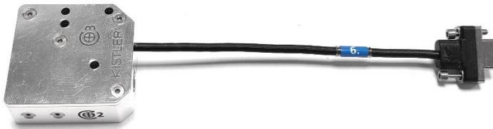
Die eigens für den THOR-5F ATD von Kistler entwickelten IMUs mit integrierter DTI-Technologie vereinen sechs Messkanäle auf engstem Raum. Sie sind im Kopf, Brustraum, Becken und den Füßen angebracht und messen die Aufprallkräfte.
