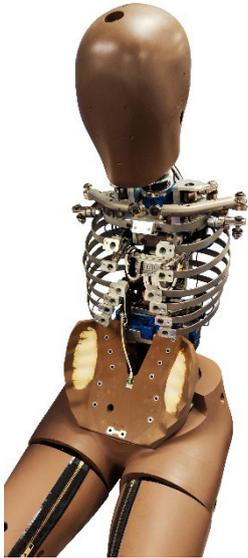
Der neue THOR-5F ATD von Kistler und Cellbond zeichnet sich durch eine verbesserte Biofidelität und leichtere Montage aus. Hier ist der vereinfachte Rippenaufbau sichtbar.
