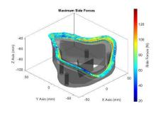
Nach Analyse der dynamischen Steifigkeit wird ein neues NC-Programm für die Fräsmaschine berechnet: Es optimiert die Schlüsselparameter und führt zu verbesserter Zerspanleistung und höherer OEE.
