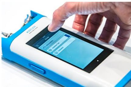
Die neuen Handheld-Ladungsverstärker von Kistler sind für die Kontrolle von Prozessparametern und die Prozessverifizierung in Industrie und Labor konzipiert.
