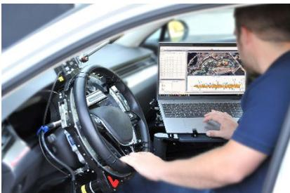
jBEAM ソフトウェアと新しい「jBEAM Durability」を活用すれば、一連の耐久性と車両ダイナミクスの試験を効率的に実施でき、車両でもテストスタンドでもビッグデータを取得できるようになります。
