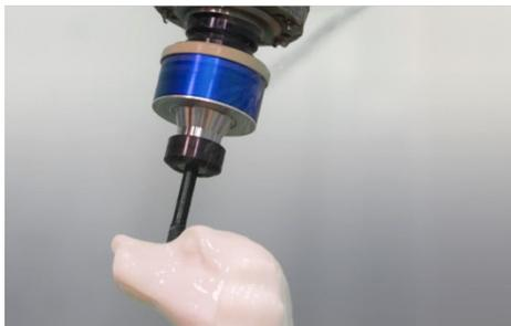
Das kabellose RCD wurde bereits ausgiebig von Kunden getestet: Eine chinesische Forschungseinrichtung hat das RCD für die Überwachung und Analyse von Prozessen zur maschinellen Bearbeitung von Steinen eingesetzt.
