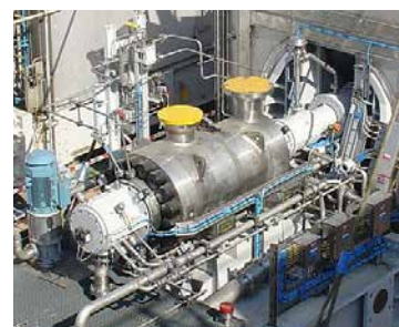
Die Hochdruck-Kreiselpumpen Sulzer HPCp wurden mit Messtechnik von Kistler entwickelt. Sie setzen neue Maßstäbe in der Branche, beispielsweise bei der Wasserinjektion in der Ölförderung.
