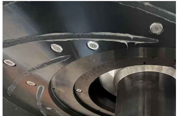
Innenansicht einer Pumpenkomponente in der Entwicklung mit bündig eingebauten Drucksensoren von Kistler
