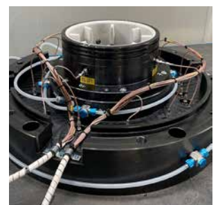
Pumpenentwicklung: Außenansicht einer instrumentierten Komponente, die mit Drucksensoren und Verkabelung ausgestattet ist
