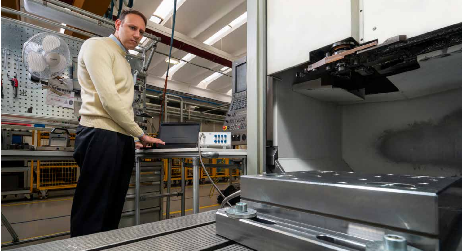
Entwicklung von Elektrospondeln bei HSD Mechatronics: Manuel Camperchioli arbeitet regelmäßig mit dem Dynamometer 9255C von Kistler, um die Dynamik der Zerspanung zu analysieren und Innovationen voranzutreiben.
