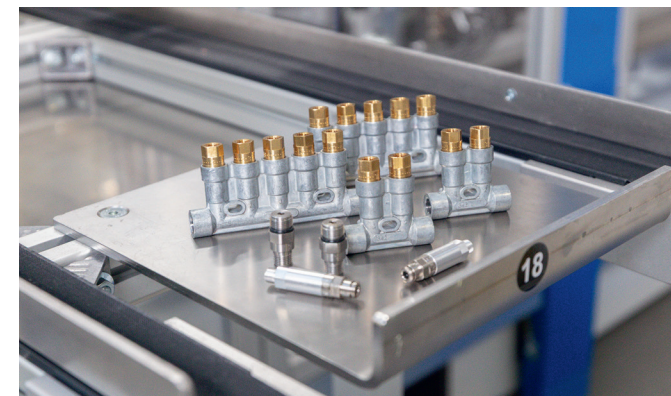
Mit der flexiblen automatisierten Montageanlage von TEAM Automation Berlin ermöglicht die Servopresse von Kistler die präzise und wiederholgenaue Montage. So kann SKF verschiedene Varianten der Schmierstoffverteiler bei kurzen Taktzeiten effizient fertigen.
