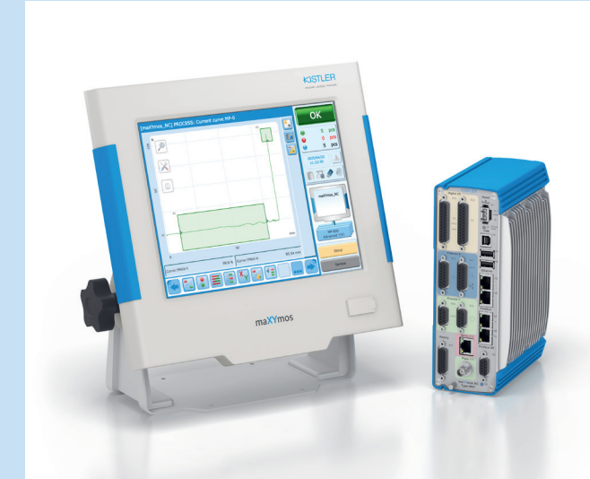
Das Prozessüberwachungssystem maXYmos NC Typ 5847B steuert, überwacht, bewertet und dokumentiert XY-Verläufe von Füge- und Einpressvorgängen in Verbindung mit NC-Fügemodulen und dazugehörigem Servoverstärker IndraDrive.
