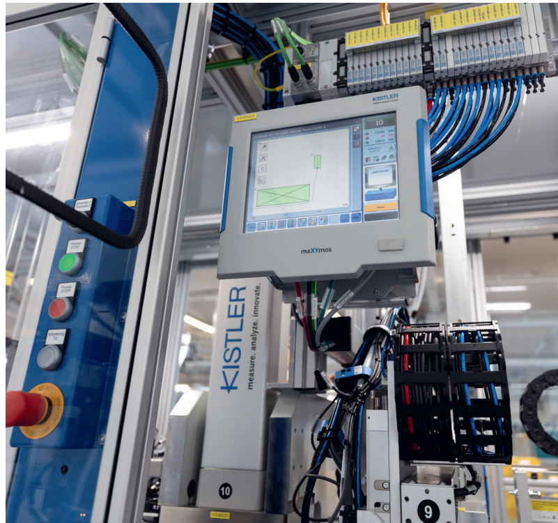
Das Prozessüberwachungssystem maXYmos NC von Kistler bewertet und dokumentiert die XY-Verläufe der Fügevorgänge.
