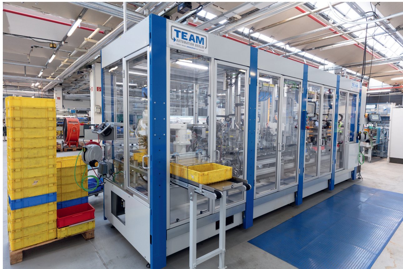
Vollautomatisierte Fertigung von Schmierstoffverteilern: Präzise Montage vielfältiger Varianten mit kurzen Taktzeiten – unterstützt durch Kistlers Servopresse und Prozessüberwachung mit maXYmos NC.
