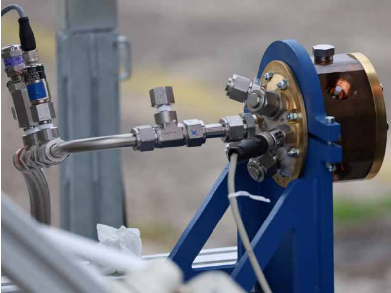
Innovativer Raketenantrieb: Aufbau der Rotating Detonation Rocket Engine (RDRE) von ARIS Perseus mit Annulus (Ringraum) und Einlässen für die Brennstoffe.
