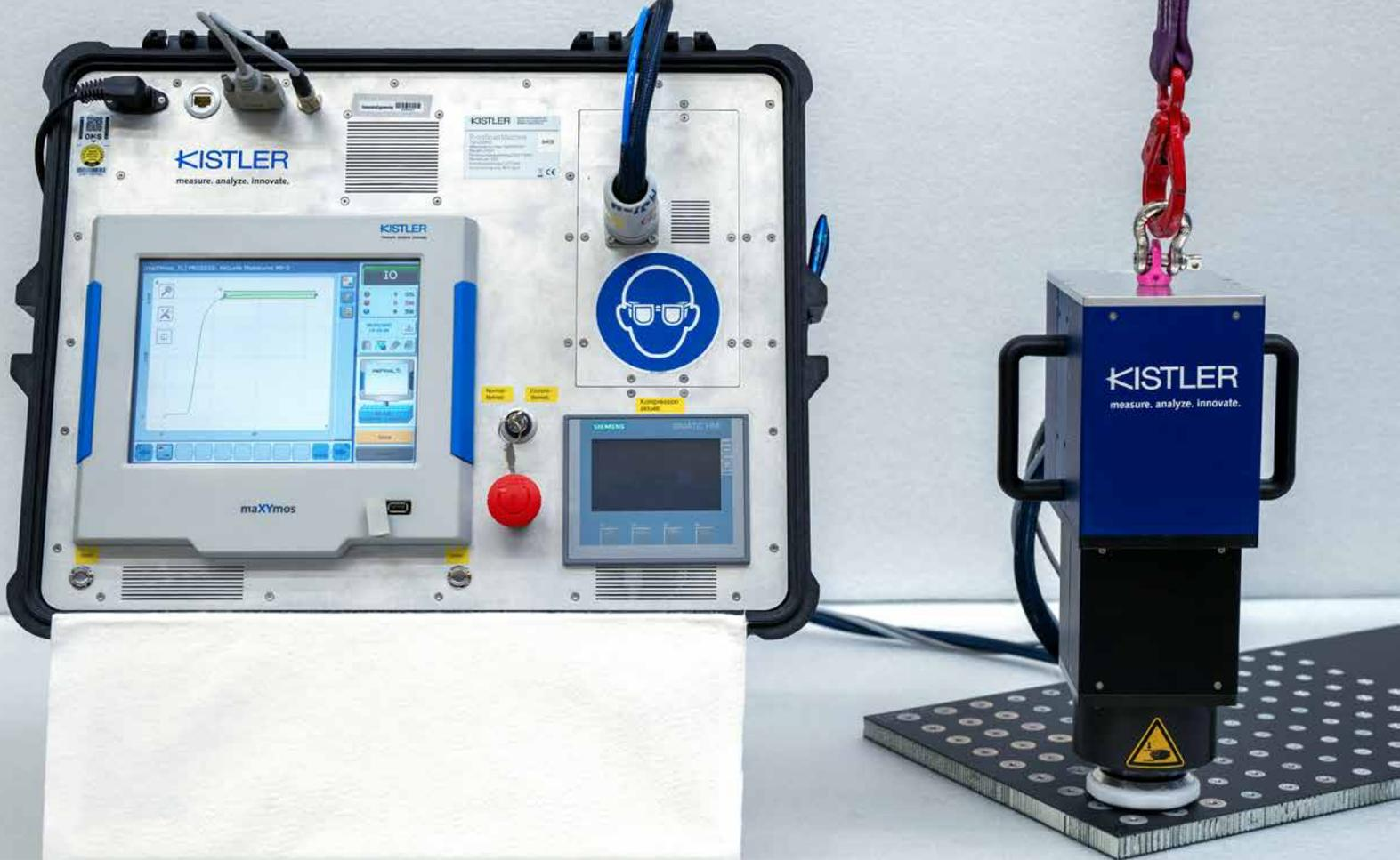
Die mobile Zugprüfmaschine von Kistler für Satellitentests bei Beyond Gravity besteht aus dem Prüfkopf mit integrierter Sensorik und dem Elektronikoffen mit Prozessüberwachungssystem.
