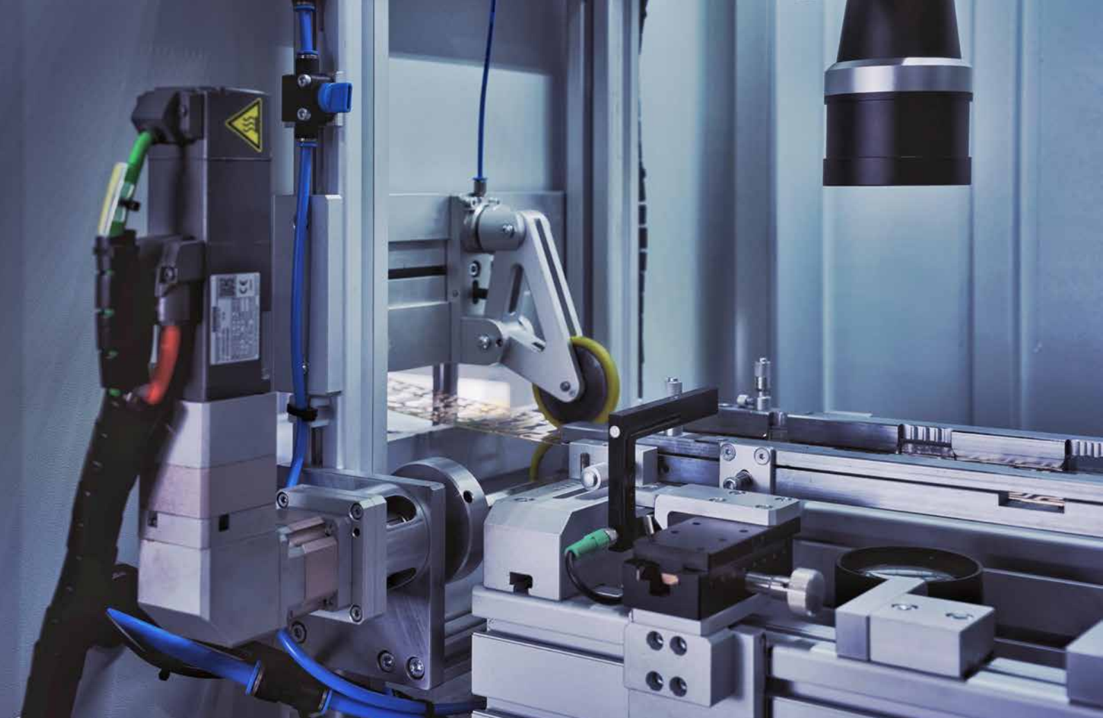
在天龙技术中心团队的建议下，奇石乐专家为即将进入KVC621视觉检测系统的冲压料带集成了一道前序清洁工艺。
