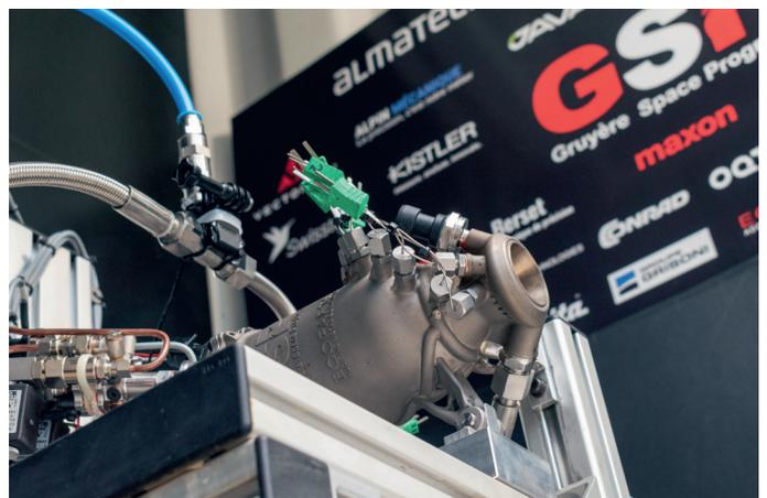
Die Drucküberwachung in der Brennkammer erfolgte mit dem piezoelektrischen Drucksensor 601CAA von Kistler, der in einem kleinen Kanal installiert wurde, der vom Einspritzkopf zur Kammer führt (blaues Kabel).
