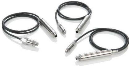
Die Optimierung der Verbrennung kann bei Großmotoren verschiedener Bauweisen durchgeführt werden. Der Zylinderdrucksensor 6636A2 hat einen kleineren Sensorkörper und ein M10-Gewinde, während der Sensor Typ 7636A2 mit einem M14-Gewinde ausgestattet ist. Auf der rechten Seite ist der Sensor (6635A1) für den Einsatz in Viertakt-Großmotoren dargestellt.
