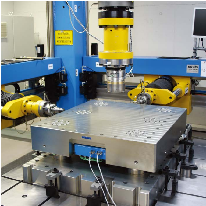
在奇石乐的3分量基准力压力机上校准
