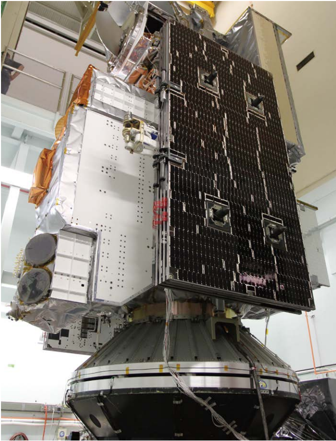
卫星环境振动试验 – 随机正弦振动 – (来源: 美国国家航空航天局)
