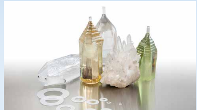
Kistler hat einen eigenen Kristall entwickelt und hergestellt, der herkömmlichen Quarz bei anspruchsvollsten Anwendungen zur piezodynamischen Kraftmessung ersetzt.
