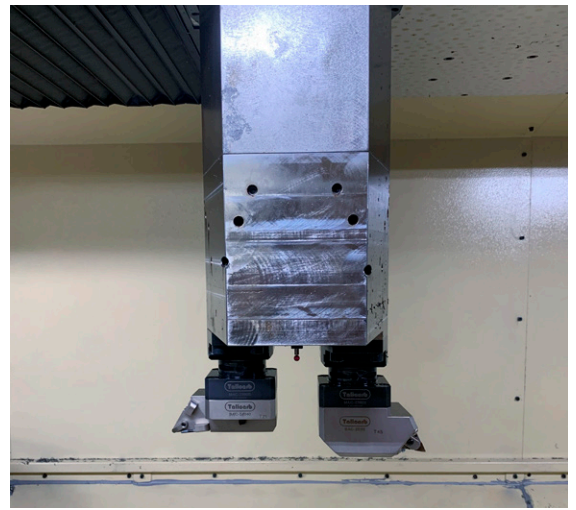
Abb. 3: Der Stößel der Maschine, in dem die Halter der Schneidwerkzeuge eingespannt sind.
