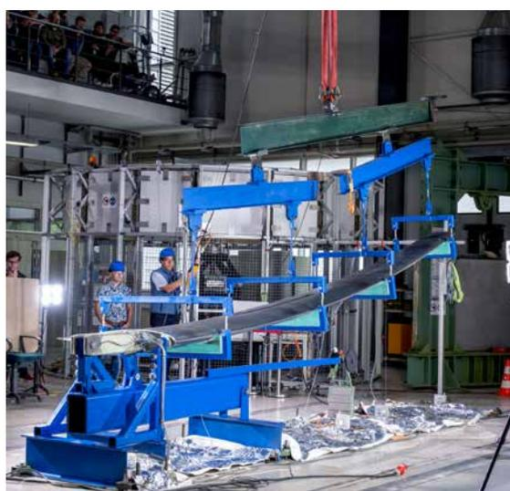
Bruchversuch am Flügel des geplanten Segelflugzeugs kurz vor dem Bruch: Oben zwischen dem Stahlträger (grün) und der Aufhängung des Lastgeschirrs (rot) ist die Kraftmessdose von Kistler installiert.
