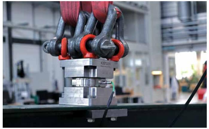
Messtechnik von Kistler im Detail: der piezoelektrische Kraftsensor 9377D bis 150 kN ist zwischen Lastgeschirr und Kranaufhängung installiert und misst die auf den Flügel aufgebraachte Last dynamisch und hochgenau.
