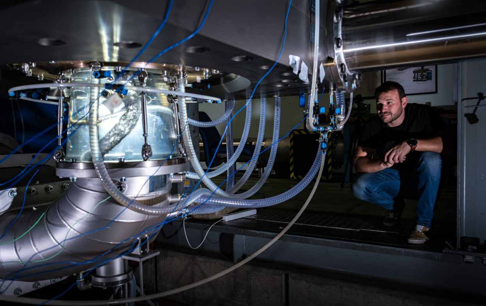
Kavitation wird während der Modellabnahmeprüfungen an einem maßstabsverkleinerten physikalischen Modell einer Pumpturbine sichtbar gemacht, das auf einem Prüfstand installiert ist (Bild: PTMH).
