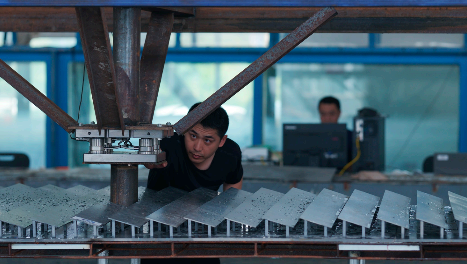
Offshore-Strukturen-Test: Dr. Hu Jielong vom TIWTE inspiziert die Installation des wasserfesten Dynamometers von Kistler unter der Plattform für eine auf dem Meer installierte Photovoltaik-Anlage.
