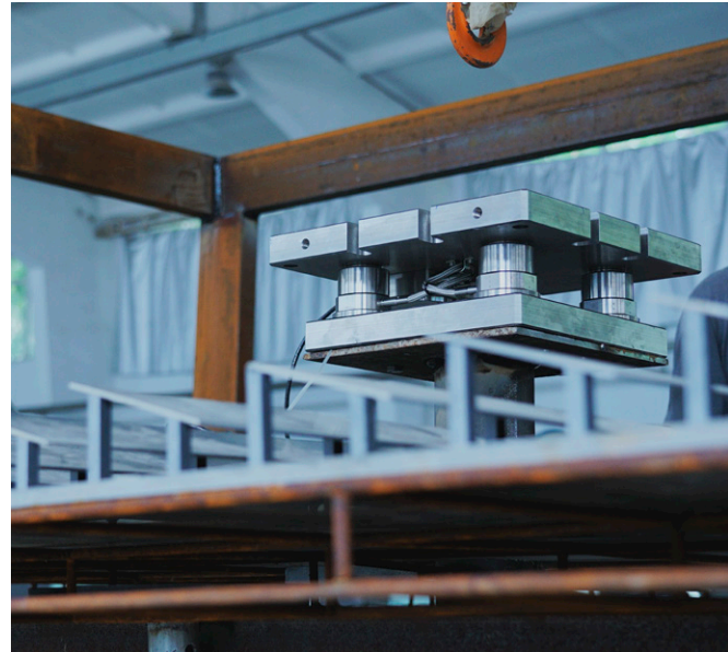
Ein für hydrodynamische Tests entwickeltes Dynamometer von Kistler versorgt die Forscher am TIWTE mit präzisen Messdaten auch unter Extrembedingungen.
