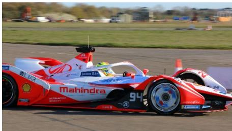
Das RoaDyn Racing Messrad ist mit vier hochpräzisen Sensoren ausgestattet, die die auf die Räder wirkenden Momente und Belastungen messen. Er ermöglicht es den Motorsportteams, die Rennstrategie und das Reifenmanagement zu optimieren sowie die Sicherheit für Fahrer und Zuschauer deutlich zu erhöhen.
