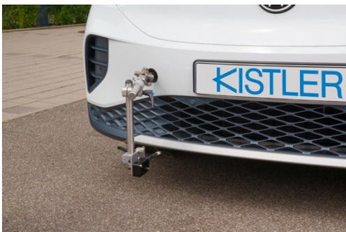
Der optische Sensorkopf des Correvit KiMotion Racing lässt sich für Fahrdynamik-Messungen nicht nur an Rennfahrzeugen anbringen, sondern auch an Straßenfahrzeugen. Anbringungsarten: Außen am Fahrzeug (im Bild dargestellt), direkt am Rad, am Fahrzeugchassis, am Fahrwerk oder hinter Verkleidungen – wie im Motorsport meist üblich. Kistler bietet zu diesem Zweck das jeweilige Zubehör, um eine perfekte Montage am Fahrzeug zu gewährleisten.
