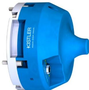
Die Drehmomentsignale des neuen Drehmoment-Messrads RoaDyn P109 von Kistler werden per Telemetriemodul drahtlos an die Bordelektronik im Fahrzeug übertragen.
