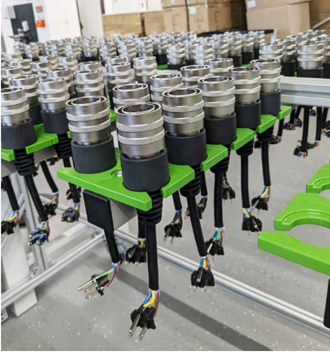
Die hohe Qualität der Ladestecker mit Temperaturüberwachung für Elektroautos wird mittels integrierter Prozessüberwachung beim Stanzen sowie optischer Inspektion mit Vision-Systemen erreicht.
