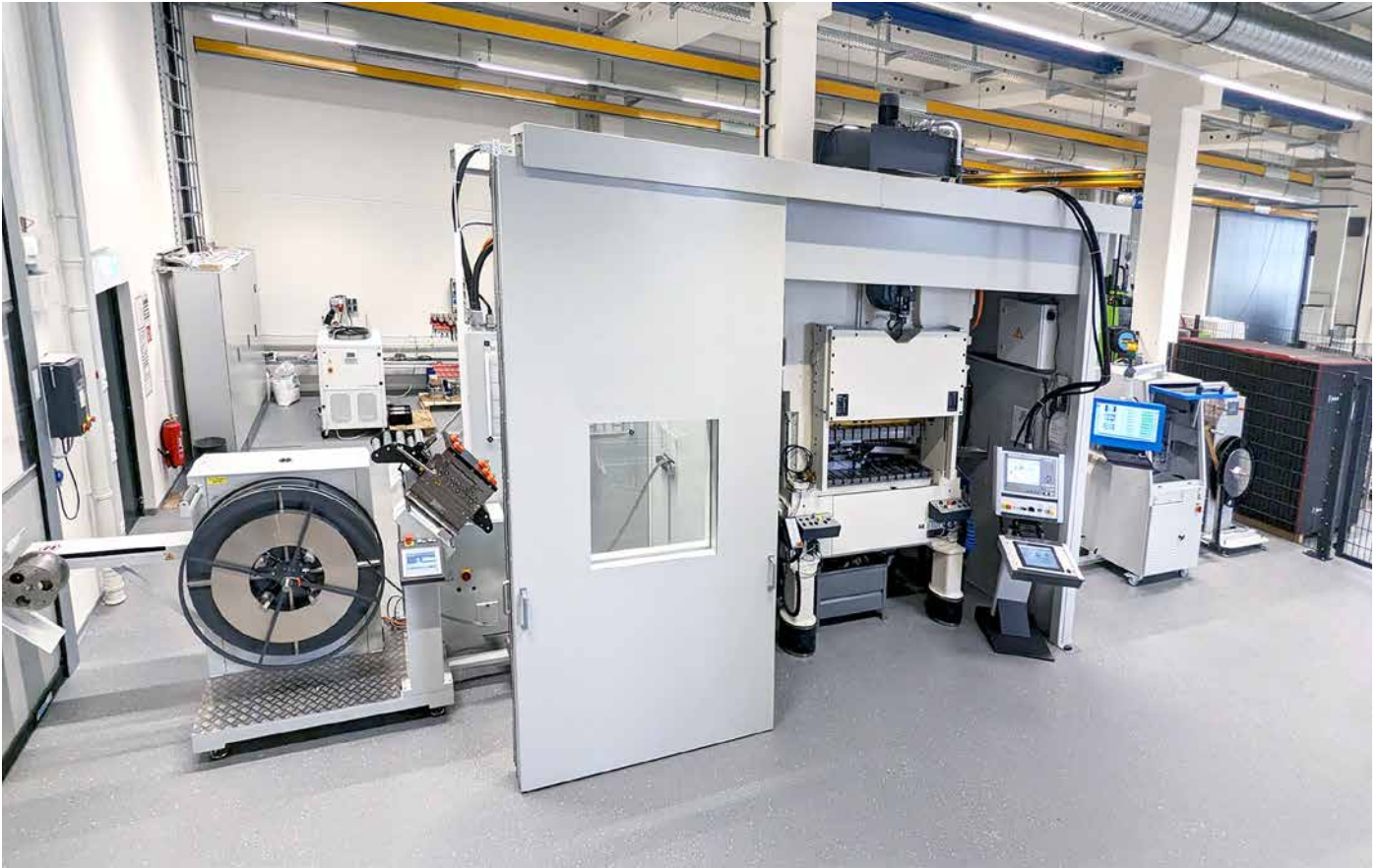
Komplette Stanzlinie für Ladestecker mit Temperaturüberwachung – mit integrierter Prüfstation für die optische Vision Inspection.
