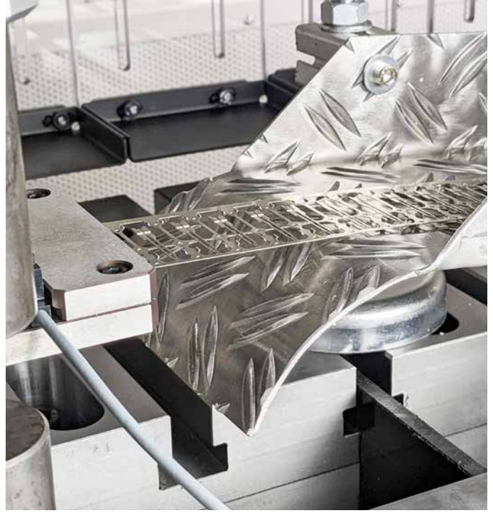
Die Hybrid-Stanzteile für die Ladestecker mit Temperaturüberwachung laufen dank Auswurfkontrolle mit integrierter Sensorik von Kistler sicher im Stanzstreifen.
