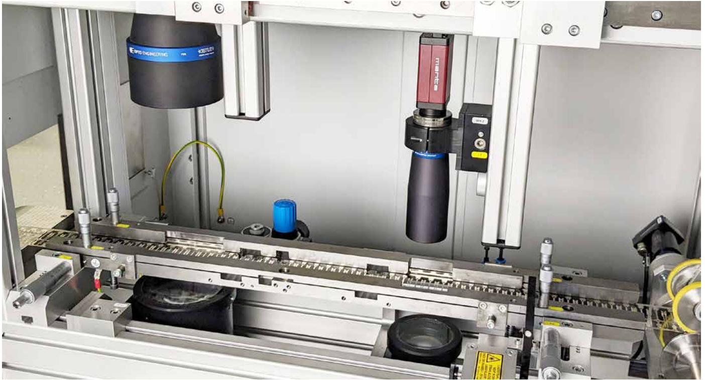
Bei BGF EnzTech sorgt die Vision-Prüfzelle KVC 621 von Kistler mit zwei Kamerasystemen für die Qualitätssicherung der Stanzteile.
