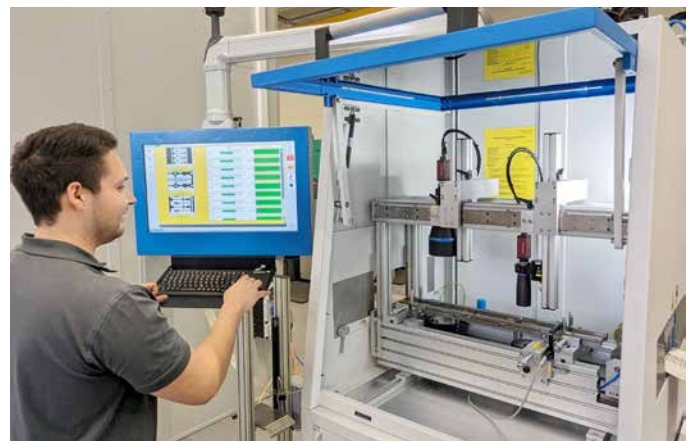
Die optische Inspektion von Stanzteilen erfolgt über ein Kamerasystem und ist über die Software flexibel auf die jeweiligen Prüfanforderungen zur Qualitätssicherung beim Stanzen, wie z.B. Maßhaltigkeit, programmierbar.
