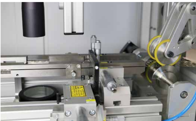
Die optischen Prüfstationen von Kistler sind modular aufgebaut und können bei Bedarf flexibel erweitert werden, z.B. um Kamerasysteme oder Lasermarkiereinheiten.
