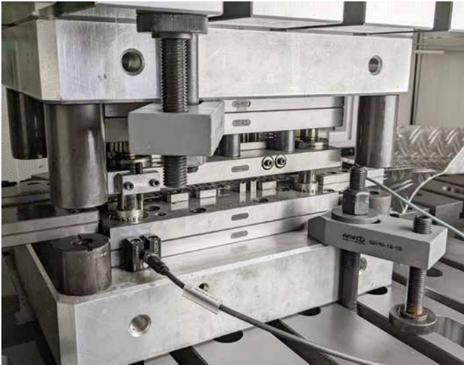
Im Folgeverbundwerkzeug sind optische und induktive Sensoren zur Vermeidung von Werkzeugschäden und zur Qualitätssicherung integriert.
