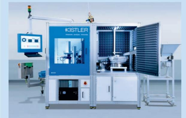
Variante des Prüf- und Sortierautomaten KVC 821 mit kontinuierlicher Zuführung; die einzelnen Prüfstationen des Drehtellers werden jedoch getaktet durchlaufen.
