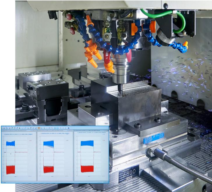
Umfassende Zerspankraftdaten des Dynamometers 9255C von Kistler helfen NIKKEN bei der Entwicklung und Optimierung seiner Werkzeughalter-Lösungen für Hochleistungsbearbeitungen.
