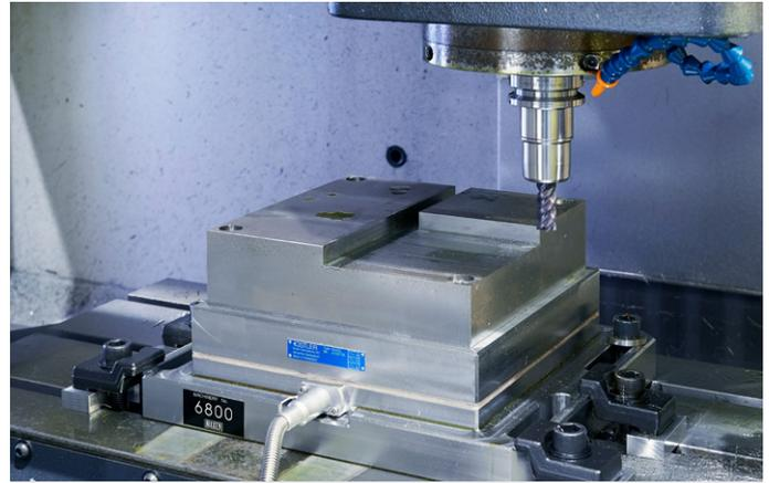
Das Dynamometer 9255C von Kistler ist ein mehrachsiger Kraftsensor für robuste und genaue dynamische Messungen bei Zerspanungsanwendungen in F&E und Fertigung.
