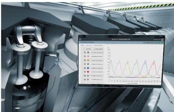
Die kontinuierliche Überwachung von Großmotoren mit Zylinderdrucksensoren von Kistler ermöglicht einen geschlossenen Regelkreis (CLCC) zur Effizienzsteigerung und Emissionsreduktion.
