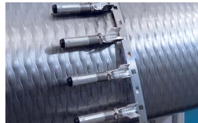
Die Qualität des von KRAMSKI endlos gefertigten Hochvoltsteckverbinders – links die Kunststoffkappe in schwarz – wird mit Hilfe von Prozessüberwachung sowie weiteren Prüfsystemen von Kistler gesichert.
