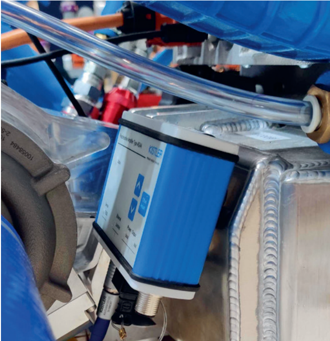
Forze ハイドロジェンレーシングのモータースポーツレーシングカー「Forze IX」には、キスラーのアンブ（型式 4624AK）が組み込まれています。このアンブが各種ピエゾレジスティブ圧力センサからの信号を、水素自動車の制御システムに送信しています。
