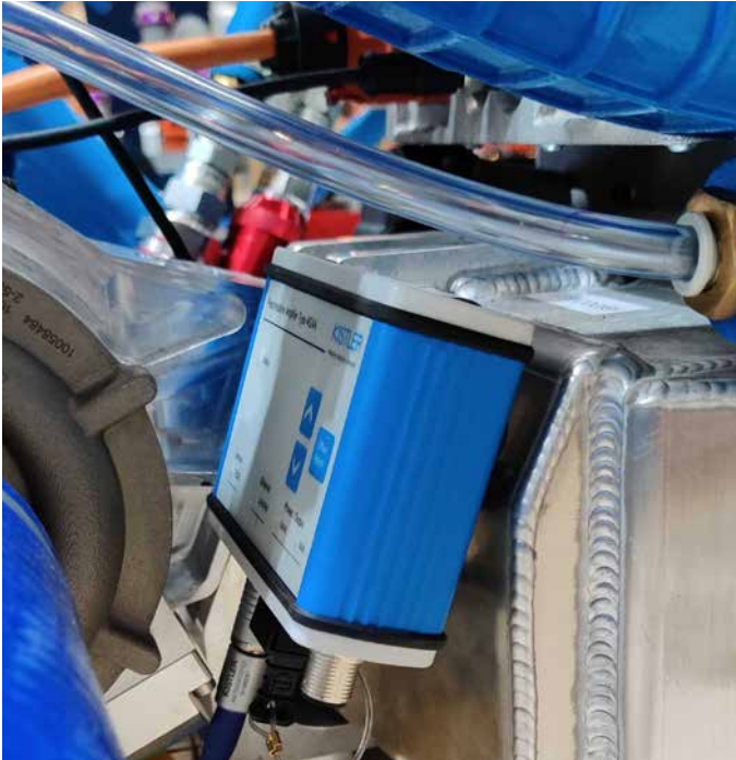
Der Verstärker 4624AK von Kistler ist integriert im Motorsport-Boliden Forze IX von Forze Hydrogen Racing – er überträgt Signale verschiedener piezoresistiver Drucksensoren an das Steuerungssystem des Wasserstoffautos.
