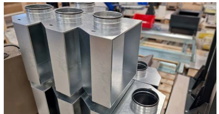
Montierte Lüftungsgehäuse, die aus sechs Blechteilen mit insgesamt 34 Clinchpunkten verbunden werden
